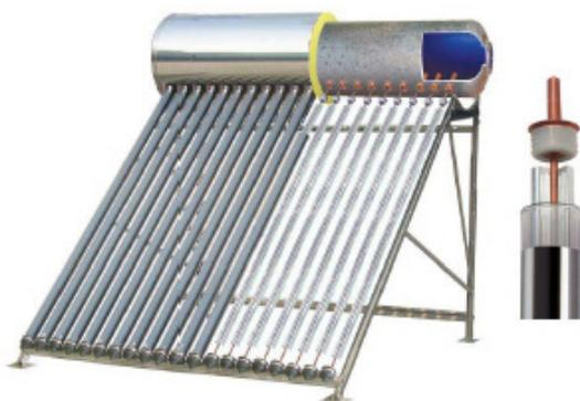
Бак солнечных термосифонных гелиосистем Sunlit® изготовлен из нержавеющей стали сварным способом, что обеспечивает продолжительность и надежность использования установки более чем 20 лет. Благодаря высокоэффективной полиуретановой изоляции тепло сохраняется в накопителе до 80 часов. Специальная конструкция каркаса позволяет устанавливать гелиосистему под разными углами на горизонтальной поверхности, а так же выдерживать порывы ветра до 140 км/час.
